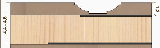
Con la opción PBM, tenemos un grueso total de 4,4-4,5 cm, con mecanizado de corte de plancha a una cara para el cajeadado de cerradura. Disponibles para EC-D12T1, ER-D12T1, EC/ER-D12T2
